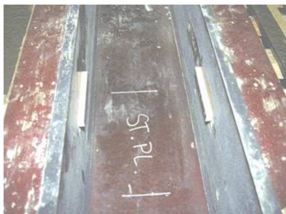
3.1 Støpeform klargjort for tosidig BSF løsning NB!Viktig
