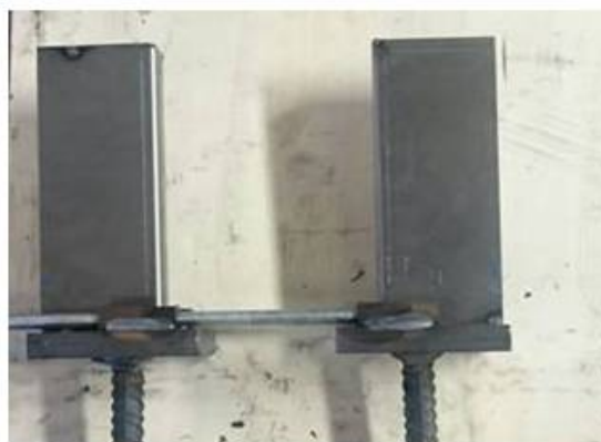
1.6 Tosidig søyleenhet med gjengestenger som holder de sammen
