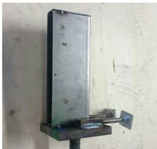
1.4 Enkel søyleenhet, påmontert gjengestang og skiver
