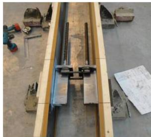
2.4 Dobbelt søyleenhet montert i form
