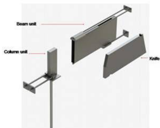
1.1 BSF-enhet , består av kniv bjelke- og søyle - enhet
