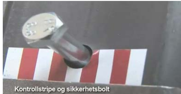
M12: Innerrøret i riktig posisjon og låsebolt montert.
